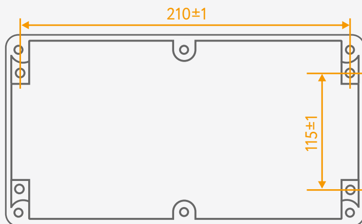
Рисунок 16 – Присоединительные размеры вычислителя
