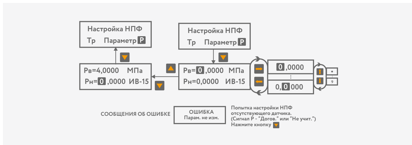
Рисунок 6.2 – Последовательность действий по настройке НФП датчиков давления
