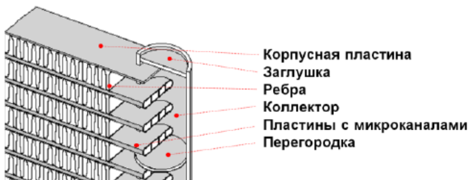
Устройство теплообменников микроканальных типа МСНЕ.
